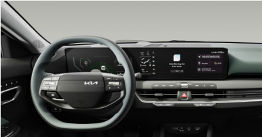
"Supervision" табло с дигитални уреди и 4.2-инчов инфо дисплей
