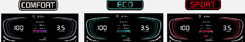
"Drive mode select" система за промяна на настройките на двигателя и скоростите за A/T
